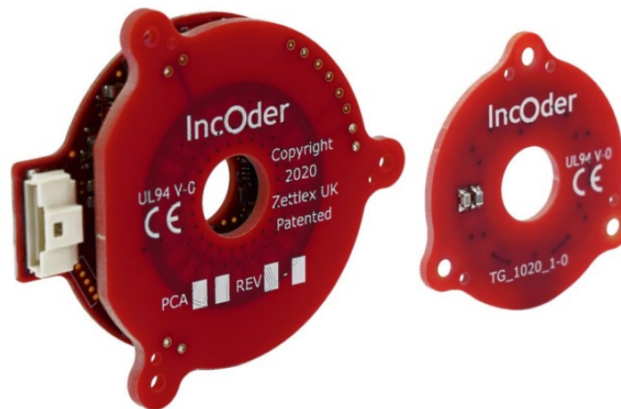
Fig.2: Unhoused IncOder (IncOder CORE – 44mm OD)
